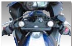
ハンドルマウントステー 204-065 ブラック ¥4,600 ナビなどのデバイスの取付に便利な マウントステー。 取付径22.2φ×取付幅約170mm。
