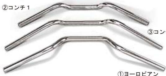
①ヨーロピアンタイプ : スチールメッキ仕上げ 径/22.2mm W685 H105 R60 L120
