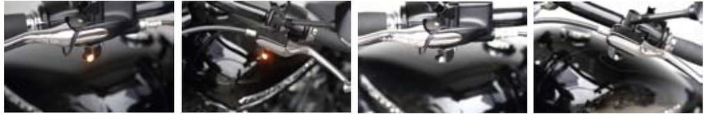
●ハーレーダビッドソンのミラーマウントタイプのウインカー装着車を中心にFLHXやヘリテージモデルナド幅広い車種に対応する超小型のNanoウインカーをフロントに装着出来るセット。普段は目立たない存在ですが、点灯時には超小型のNanoウインカーがその存在をアピールする発光をします。Eマーク取得のウインカーなので保安基準適合です。●左右取り付けステー:スチール製ブラック ●Nanoウインカー:ECE型式認証番号 50R000334
