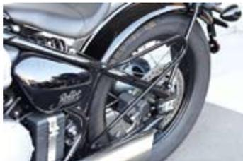
●サイドバッグを取り付ける際に巻き込み防止になるバッグサポート。独特なボバーのスタイルを崩さない様にブラック仕上げで設定。実用を考え、左側を単体で設定。●スチール製ブラック仕上げ
