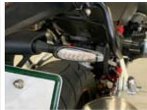
●ノーマルのLED仕様のウィンカーと交換するだけで流行の流れるウィンカー、シーケンシャルタイプに変わります。スリムなTRタイプが違和感なく車体に映えます。取付けに必要なものをセット。●内容:ウィンカー本体×4、変換ハーネス×4、マウントベース×4、ナット/ワッシャー/タイラップ ●純正ウィンカー:8522499/8522503に対応
