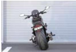
●2018年以降のソフテイルモデルをローダウンした際に立ち気味になる車体を傾斜させるスペーサーセット。●20mmダウンに対応。●アルミ製ブラックアルマイト
