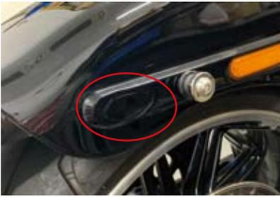
●当社製Nanoウィンカーや社外小型ウィンカーのナンバー横への装着により目立ってしまう純正のウィンカーホールをカバーするプレートが登場！取付けも付属の両面テープでの貼付けだけなので簡単。フェンダーサポートのカラーに合わせてクロームメッキ、ブラック、サテンシルバーを設定。●アルミ製アルマイト仕上げ
