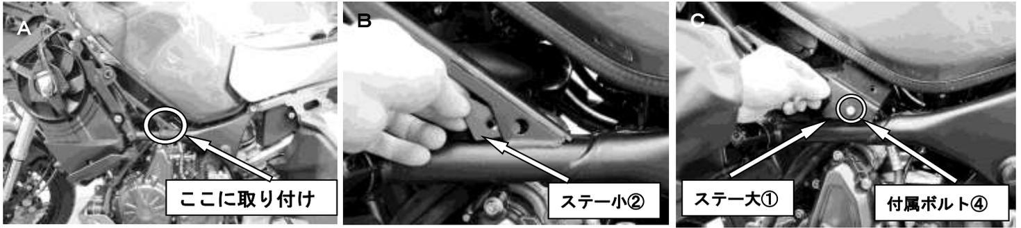
1. パーツリスト、サービスマニュアル等を参照してサイドパネルを外します。 (写真A参照)
