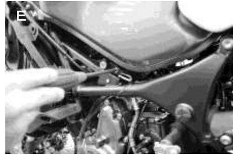
3. ステー小②が回されない様に本締めしていきます。(手を添えながら締めると回されにくいです) (写真D参照)
