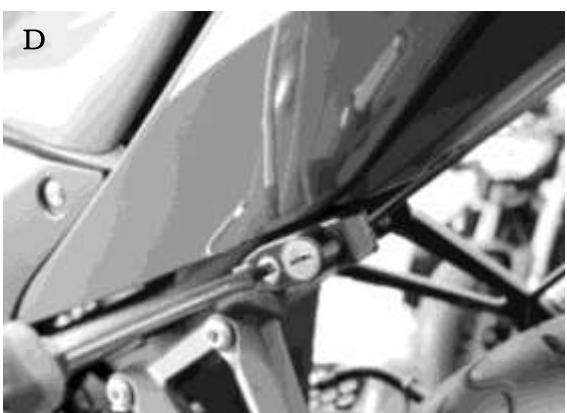
3. 2でボルトを通した、純正プラケット、ステー①を車体に組付け、ステー①に本体②を付属ボルト③で組付けます。(シートカウル等への干渉が無いように調整して下さい。)
