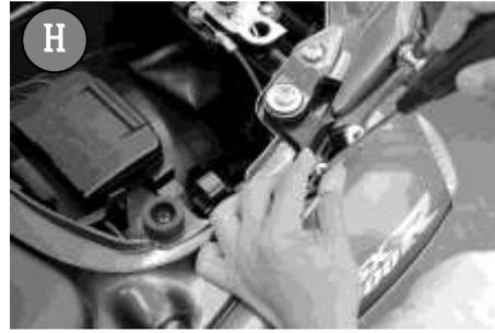
3. 車体左側に、ステー②の大きな穴にグラブレールに付いている段付きカラーを通して、車体とグラブレールの間に挟んで、付属ボルト④をガタが残る程度で仮止めします。 (写真D、図F参照)
